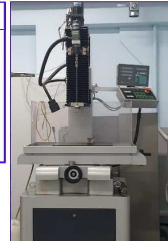
Электроэрозионный прошивной станок для получения малых отверстий Д703 (супердрель)
