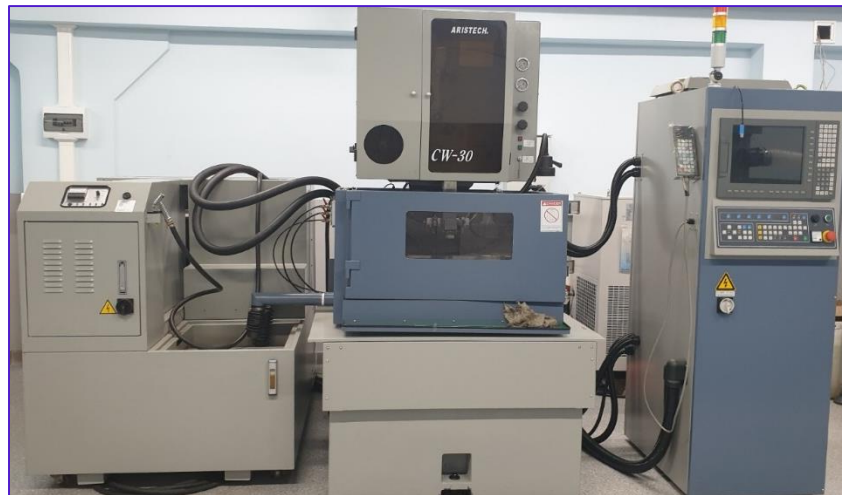
Электроэрозионный проволочно-вырезной станок погружного типа CW-30
